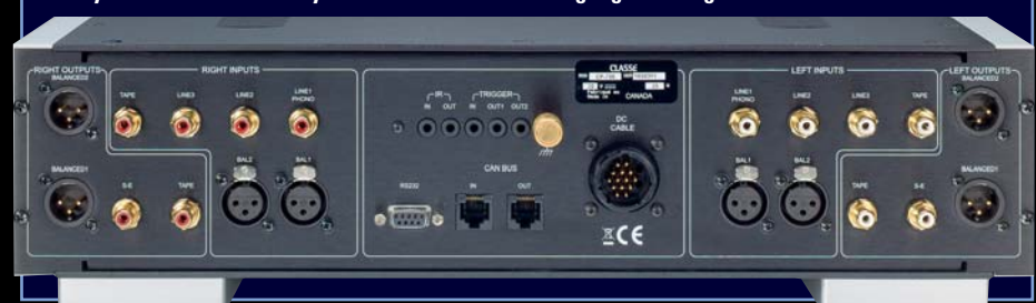
Die Vorstufe protzt unter anderem mit hochmodernen Schnittstellen (CAN-Bus, RS232, Trigger, IR) und symmetrischen wie unsymmetrischen Ein- und Ausgängen. Mittig: der Netzteilanschluss
