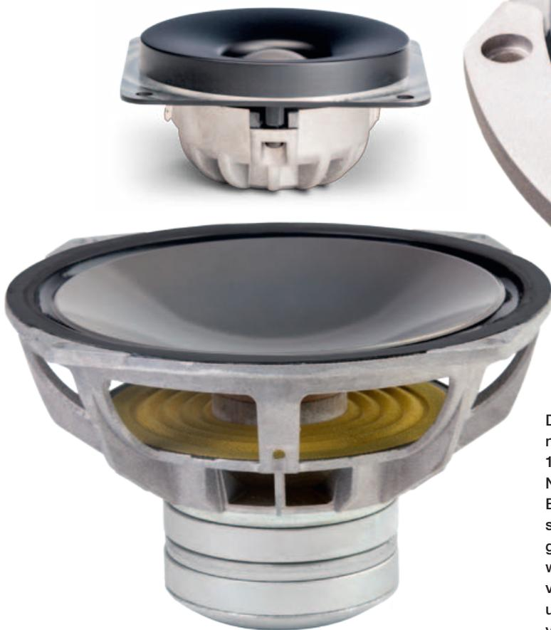
Die Einzell-Kalotte (oben links nebst Waveguide) und der 17er-Mitteltöner (links) sind mit Neodym-Antrieben bestückt. Beim Bass (Ausschnitt oben) setzt man auf oberflächlich gehärtetes Aluminium und eine wellenförmig geformte Sicke, die völlig von der Auslenkung unabhängige Rückstellkräfte verspricht.
