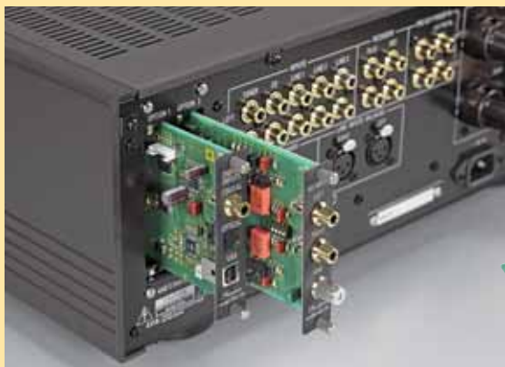
Maximal zwei Einschübe – hier für Digitalquellen und Phono – lassen sich im E-460 verwenden. Phono-MM/MC ist frontseitig umschaltbar
