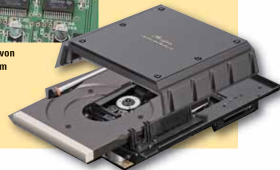
Die Funktionsgruppen Netzteil (1), Laufwerk (2), Steuerung (3) und Wandler/Ausgangsstufe (4) sind sauber voneinander getrennt
